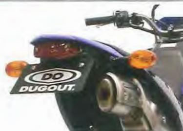
オフロード車のテールをスリムに変更。ナンバープレートとウィンカーのステーに、ルーカスタイプのテールランプを組み合わせました。ノーマルウィンカーの使用が可能です。
