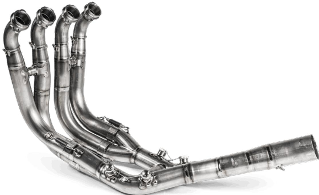
このパーツはSlip-On Lineマフラーと組み合わせることにより、パーカーフェクトなシステムにアップグレードする事が可能です。装着すると完璧なレーシングサウンドを実現し、パワーとトルクは特に中域以上で向上されます。また、このオプションヘッダーは、ノーマルサイレンサー、BMWアクセサリーのアクラボピッチサイレンサーにも適合します。完璧なパフォーマンス、スロットル応答、耐久性を実現するには、ECUの再マッピングをお勧めします。 **排気音：107.9dB/6500rpm**
