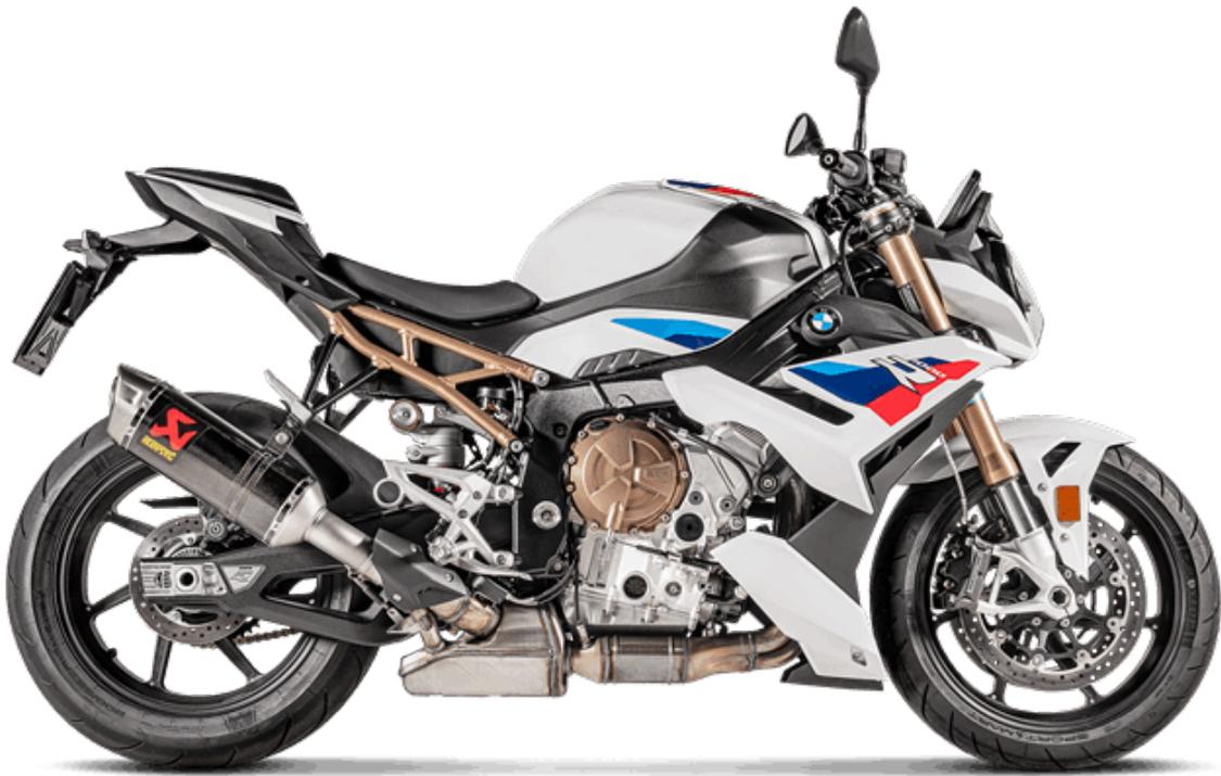
この洗練されたデザインは、製造する際にレースで証明された材料を使用し、高品質の軽量チタンリンクパイプ、チタンインナーマフラー構造、新しいスタイルのエンドキャップがすべてカーボンファイバーアウトマフラースリーブと一体化しています。純正マフラーより23%以上軽量にも成功しています。マシンがアイドリングしているときは、フルで強烈なサウンドが発せられ、移動中は独特のアクラポビッチのキャラクターを備えた深みのあるフルトーンを提供します。Akrapovic Slip-OnLine (Carbon) エキゾーストのアップグレードは、チタンとステンレス鋼の2つのオプションのヘッダーを組み合わせることで実現できます。これらは、システムとヘッダーを組み合わせた人のために、オプションのノイズインサートとともに利用できます。このEC / ECE承認済みでEuro5準拠の製品は、再マッピングを必要としないシンプルなプラグアンドプレイインストールプロセスを備えています。なお、使用可能なオプションのヘッダーをインストールすると、EC / ECE型式承認証明書が無効になります。
