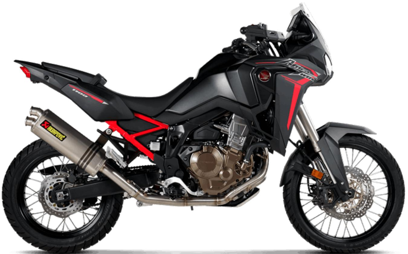
アクラポビッチレーシングシステムは、最高のパフォーマンスを要求するライダー向けに設計されています。レーシングシステムは、純正エキゾーストシステムと比較して軽量であり、並外れた生産品質、ハイテク素材、そしてもちろん純粋なレーシングサウンド出力と組み合わされたエンジン性能の向上を特長としています。ダブルフローマフラーは、六角形の形状とよりクラシックなリアエンドキャップのユニークな組み合わせで、耐久性のあるチタンマフラースリーブと頑丈なカーボンファイバークランプで仕上げられています。完璧なパフォーマンス、スロットル応答、耐久性を実現するには、ECUの再マッピングをお勧めします。
