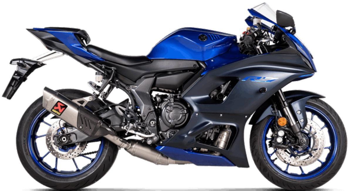
EC / ECEタイプ認定のコンプリートエキゾーストシステムで、高級軽量チタン製アウタースリーブとマフラー用エンドキャップ、ステンレス製リンクパイプとヘッダーを採用し、標準ストックより0.7kg軽量化。排気。触媒コンバーターはパッケージに含まれており、現在のEuro5承認に準拠しています。標準のストックエキゾーストに対してダイナモテストすると、9,200rpmで1.5kW (2.0 hp) のパフォーマンスが向上し、5,000rpmで+ 1.1Nmが追加されま
